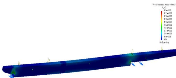
Hình 9. Kết quả phân tích ứng suất dầm cầu trục
